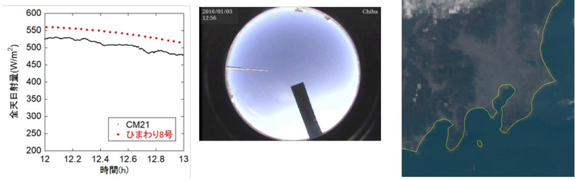
図13 想定外誤差と判定された 2016 年 1 月 4 日の全天日射量(左)、そのときの天空画像(中央)及び衛星画像(右)。
